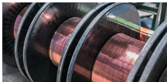
Проволоку из ниобий-титанового сплава выпускают на мощностях цеха по производству сверхпроводящих материалов АО «ЧМЗ». В изготовлении проволоки используется оборудование, ранее задействованное в производстве сверхпроводниковых материалов для крупнейших международных научно-исследовательских проектов: ИТЭР (Международный экспериментальный термоядерный реактор), FCC (Кольцевой коллайдер будущего), LHC (Большой адронный коллайдер) и других.
