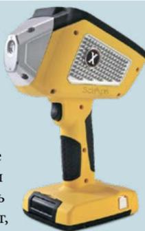
SciAps решил эту проблему, предложив новые РФА, способные измерять Mg и Si в 10 раз быстрее, чем другие «пистолеты», так что операторы могут выполнять тонкую сортировку за нескольких секунд. С улучшенной производительностью и точностью сортировка алюминиевого лома была преобразована.
